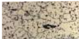
一般的な刃物鋼 粗く、不揃いな金属組織
